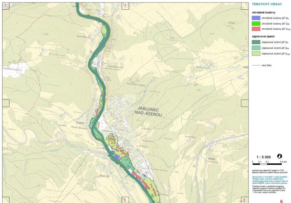
Obr. 7 Ukázka detailu mapového atlasu, jenž zobrazuje záplavová území Q_5 , Q_{20} a Q_{100} a ohrožené nemovitosti při Q_5 , Q_{20} a Q_{100} .
