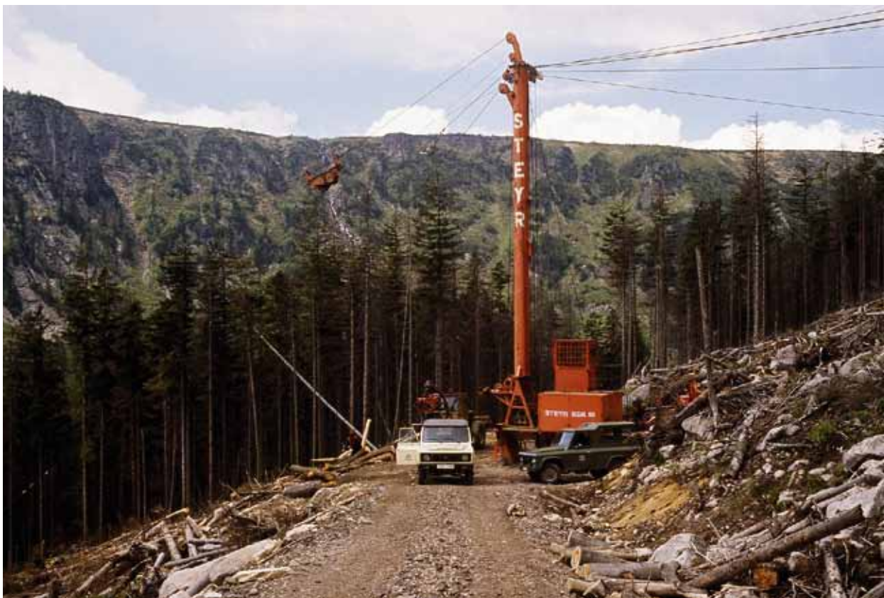
Lanovka Steyr na svážnici Lavina v Labském dole (za kladkostrojem je vidět vodopád Pančavy). Denní objem transportované hmoty tohoto výkonného rakouského výrobku byl obrovský, a tak se den za dnem vzhled přísně chráněné krkonošské krajiny rychle měnil (foto Jan Štursa)
