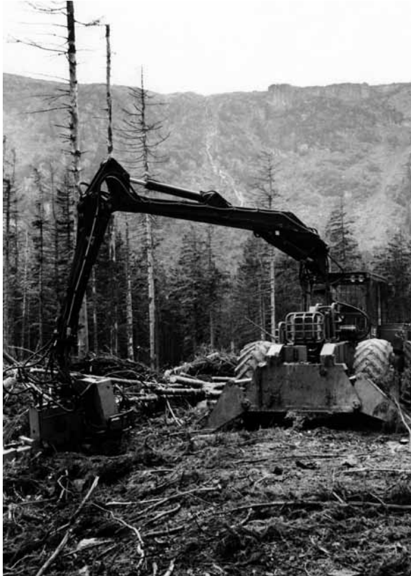
Immissionskalamität. Schwere Technik unterwegs in den betroffenen Bestand, hier wird eine Rückegasse von der Medvědí bouda bis zur Talsohle des Elbgrunds gebaut. (Foto Fotoarchiv der KRNP-Verwaltung)
