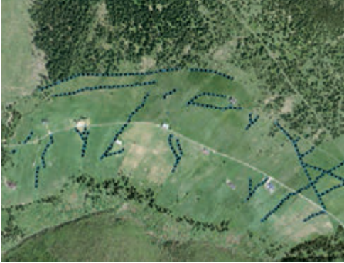
Obr. 10. Klínové Boudy – realizace odvodňovacích prvků v letech 2015–2016.
