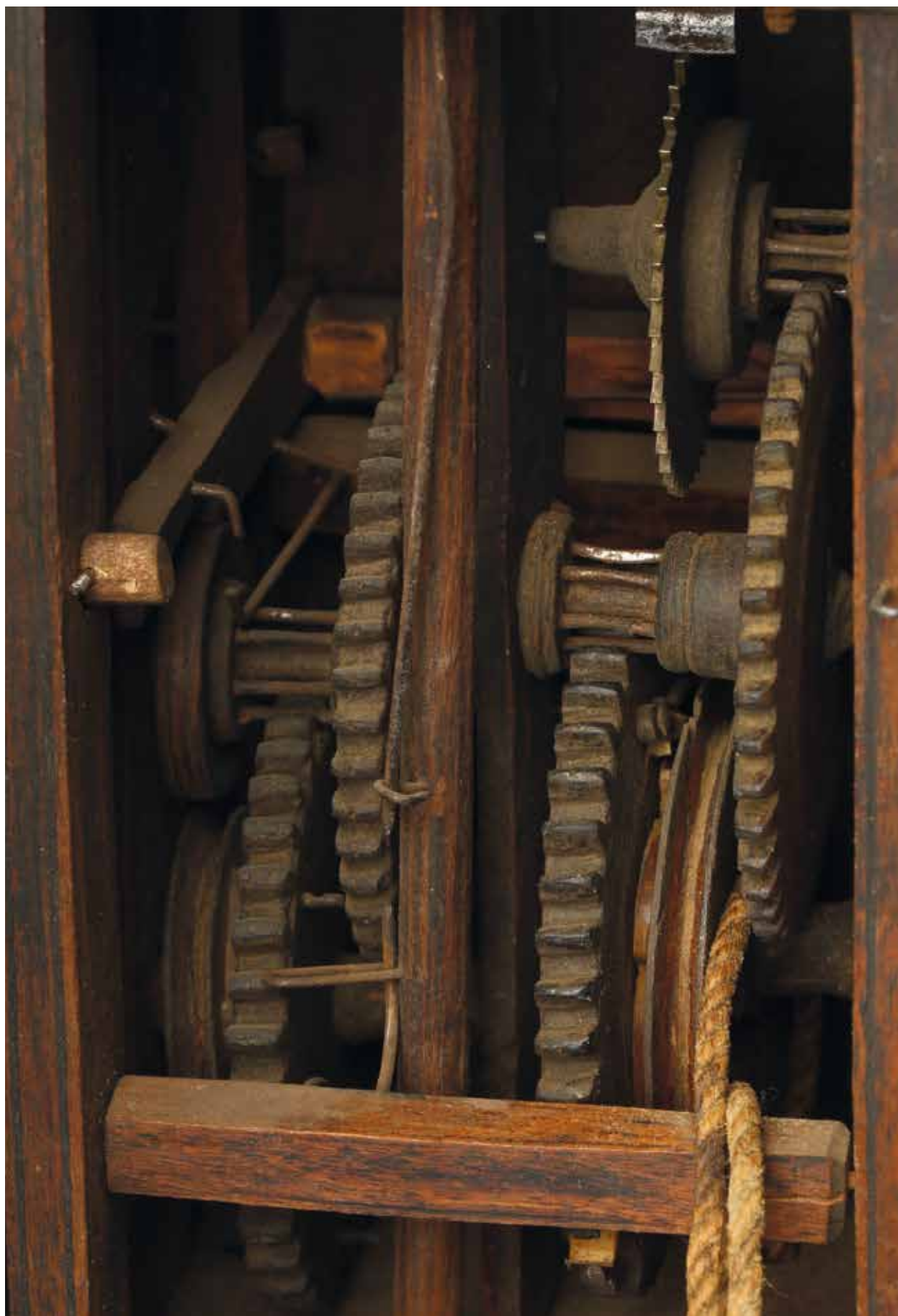
Hodiny z přelomu 18. a 19. století. Strojek hodin je z větší části dřevěný
