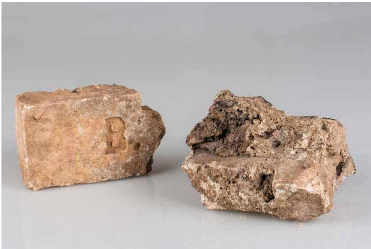
Cihly a struska ze zaniklé šachtové vápenické pece v Rudníku-Bolkově (19./20. století)
